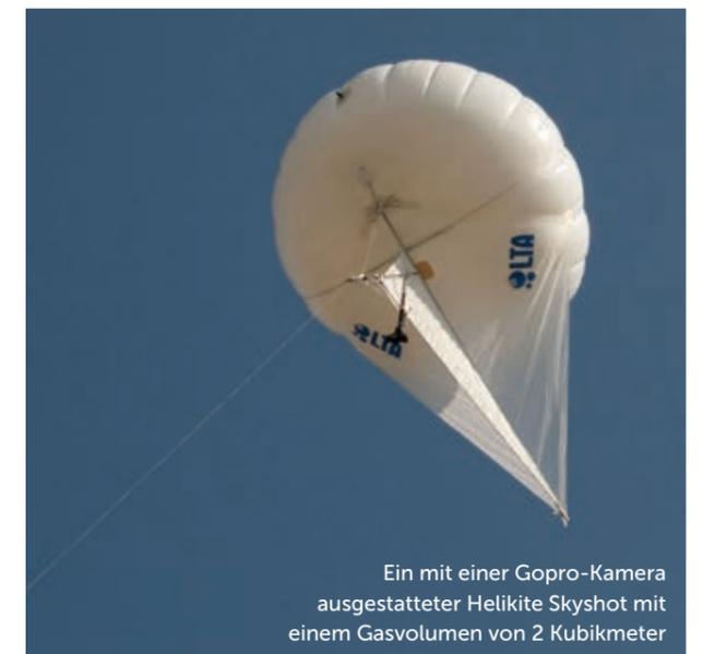
Ein mit einer Gopro-Kamera ausgestatteter Helikite Skyshot mit einem Gasvolumen von 2 Kubikmeter
